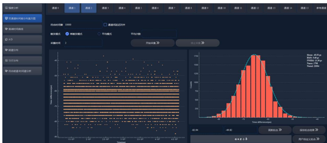
图 124 Venus 设备 2 的 CH1 和 CH2 时间差分布（内部触发，上图：使用本地 TDC 时钟；下图：使用上一级 Venus 设备 1 的输出时钟）
