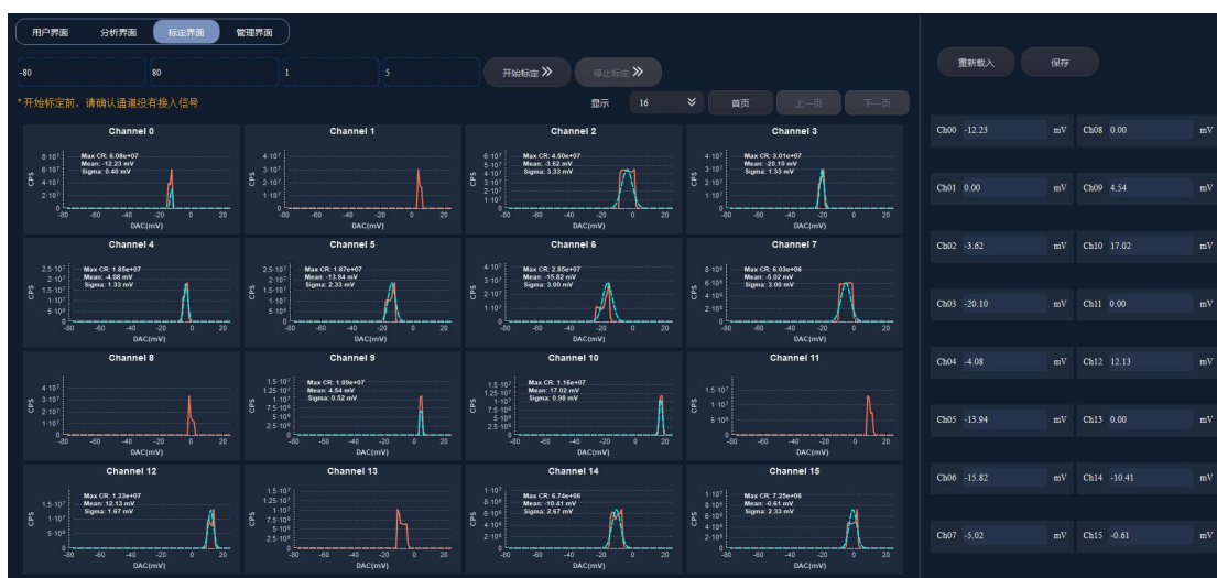
图 92 系统标定结果（迟滞电压 1 mV，标定范围-100 mV 到+100 mV，步进值 1 mV，平均次数 5，典型结果）
